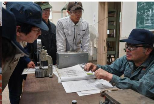
透過蕭式硬度計量測並討論金屬在經過鍛造後的硬度變化
