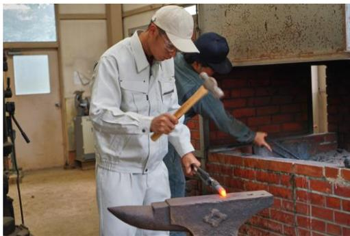
鍛造實作:將達到再結晶溫度以上的金屬施予敲擊
