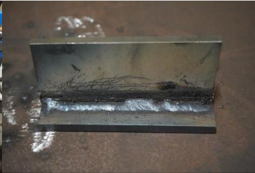
銲接作品：老師點評時表示銲接角度仍需要調整
